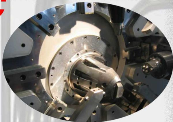
Nelle due foto sopra viene evidenziato il movimento del quill. Con il "Quill Position Control" è possibile avere un'area di lavoro molto più ampia. Gli assi X e Y si muovono di 120 mm (150 mm per HX-60) e il movimento dell'asse Z è di 60mm (75 mm per HX-60); non un semplice spostamento di qualche millimetro, ma un vero movimento che facilita ulteriormente tutte le operazioni di avvolgimento e piega.
