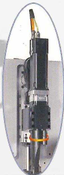
La foto a sinistra illustra la slitta superiore di avvolgimento, dotata di piegatore pivotante comandato da un asse indipendente. Con questo sistema, il passaggio da avvolgimento destro a sinistro avviene con la semplice rotazione del quill e del piegatore pivotante; è anche possibile controllare il pre-carico di avvolgimento.
